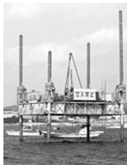
スパット台船 ボーリング地質調査のため設置されたスパット台船
